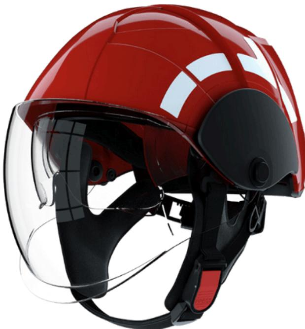
**PAB Fire Compact** je lagana i kompaktna kaciga za intervencije u zatvorenom i na otvorenom prostoru. Izrađena od ojačane termoplastike, otporna na temperaturu do 1000 °C i hladnoću do -30 °C. Usklađena sa standardima EN 443, EN 14458 i EN 166. Vizir i unutrašnje naočale pružaju zaštitu od čestica, topline i magljenja. Unutrašnjost je periva i podesiva. Težina cca 1165 g. Mogućnost ugradnje LED lampe, komunikacijskog seta i različitih zaštita za vrat. Pouzdana zaštita uz udobno nošenje.
